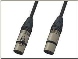
アメリカCannon社が開発したXLR型コネクタ 及びその互換品を指す。主にマイク接続用に多く用いられており、スピーカー接続用等にも使用されている。写真左がメス、右がオス。一般的にPAで使用する際はピン配置の1番Ground(GND)が、2番がHOT、3番がCOLDとなる。
