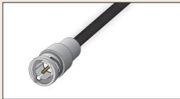
高周波(Radio Frequency)テレビやラジオが伝送される周波数バンドの信号という意味である。一般家庭では室内壁面のアンテナ出力からテレビのアンテナ入力用に使用される。
