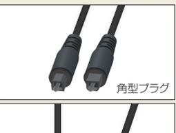
再生機やゲーム機など光デジタルでオーディオ出力を持つ機器から、AVアンプなど光デジタル入力を持つ機器へ接続するために使用される。ケーブルに光ファイバーを使用しているので 電氣的な影響を受けることがなく、安定した供給ができる。しかし、長距離が通わせないことや光ファイバーの素材などによって音が変わってくる可能性があるため、業務用ではあまり使用されない。
