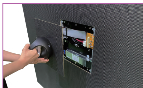
フロントメンテナンス
